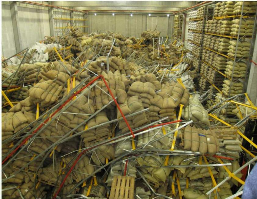
Vista del magazzino dopo il crollo degli scaffali con sistema di prelievo con carrelli filoguidati con operatore a bordo
